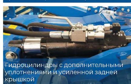
Гидроцилиндры с дополнительными уплотнениями и усиленной задней крышкой
