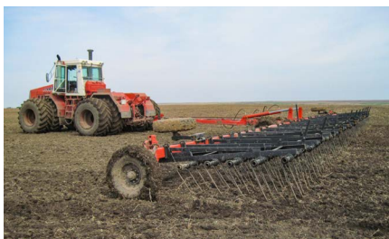
БОРОНА ПРУЖИННАЯ БП-21 В АГРЕГАТЕ С ТРАКТОРОМ К744 Р4
